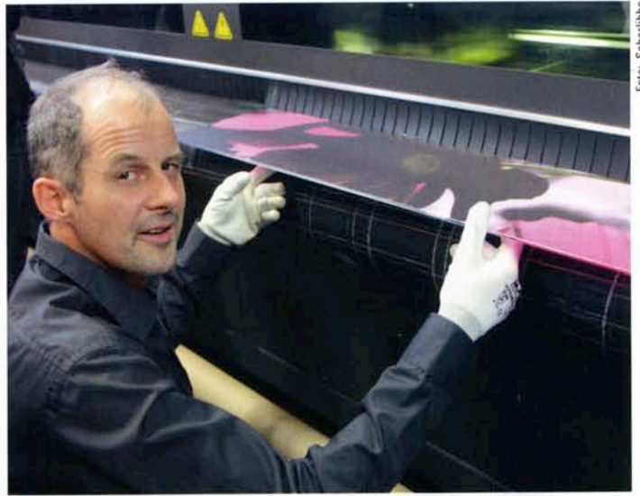
Individuelle Türen: Lothar Witte, Geschäftsführer von „Colora Druck“ zieht die frisch bedruckte Glasplatte aus dem sechsfarbigem UV-Drucker. Die mit einem Blumenfoto versehene Scheibe kann als Türfüllung eingesetzt werden, und kostet zirka 250 Euro.
